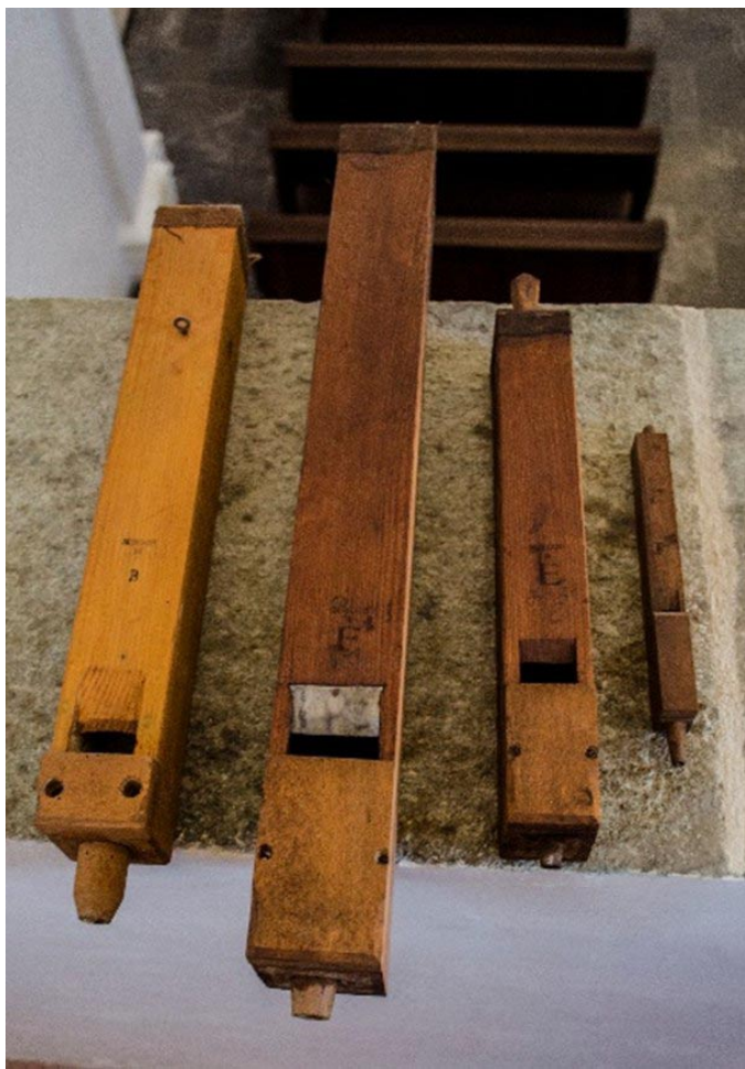
Sl. 3. Primerjava štirih piščali od leve proti desni: Burdon 8' – Dernič, 1912; Kopel 4' (popravilo ust); Kopel 4' – skoraj neokrnjena piščal, Rotenburger, 1639; Burdonček 8' – Derničeva dodatna piščal. (ar)
